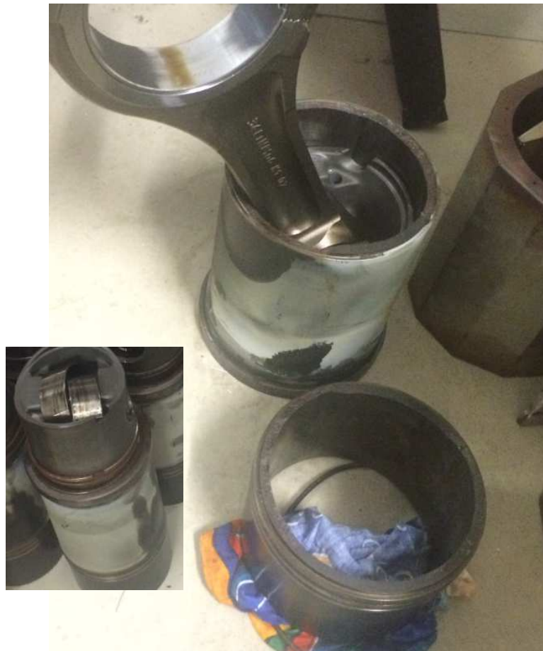
Laufbuchsenabriss, BHKW Niendorfer Str.
